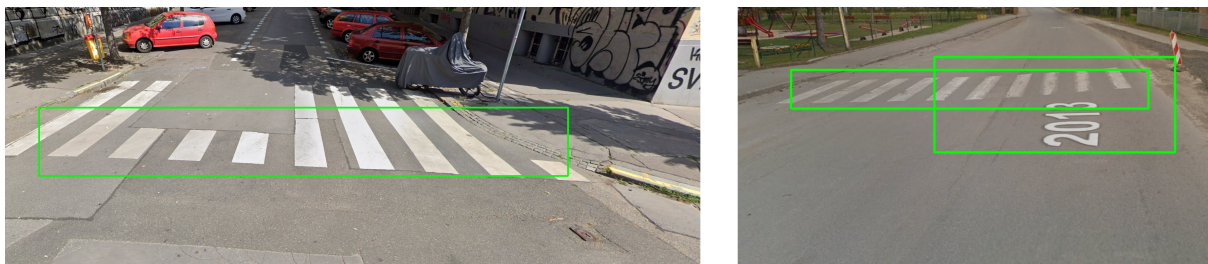
Obr. 35: Zle viditeľné alebo neúplné prechody a ich vyhodnotenie natrénovaným modelom
