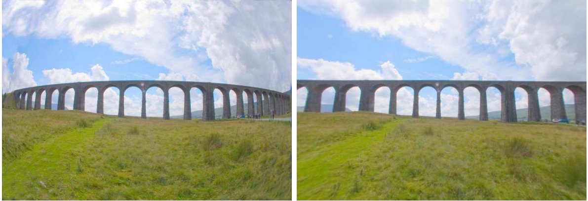
Obrázek 2: Původní zkreslený obraz (vlevo), obraz po odstranění radiálního zkreslení (vpravo)
