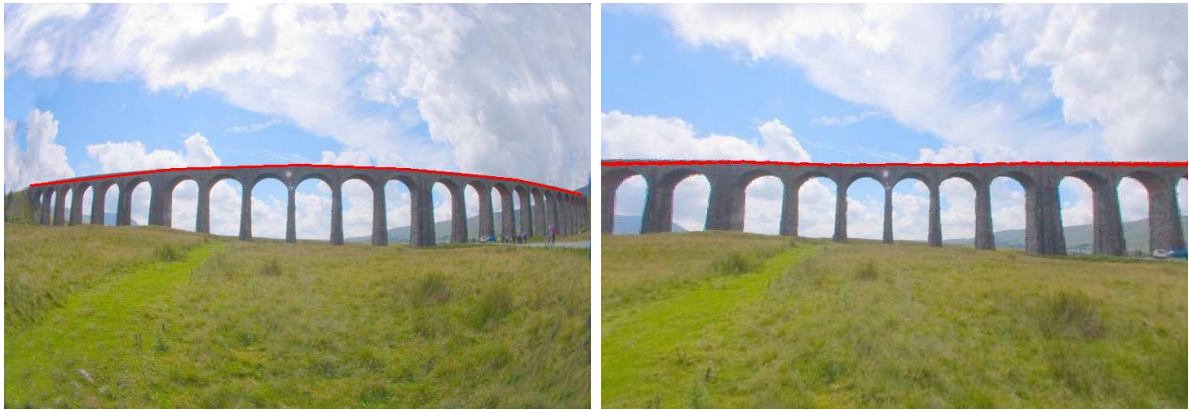
Obrázek 3: Původní zkreslený obraz s uživatelem definovanou lomenou čarou (vlevo), obraz po odstranění zkreslení pomocí automatické kalibrace (vpravo)
