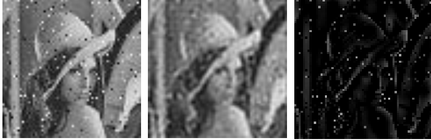
Obr. 3 Vstupní obraz (vlevo), dolní propust (uprostřed), horní propust (vpravo)
